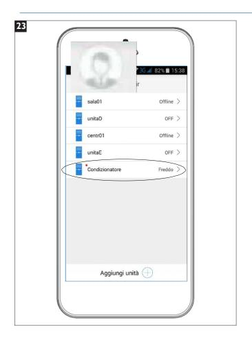
Если напротив найденного устройства появилась красная точка, это означает необходимость обновления программного обеспечения Wi-Fi модуля этого устройства
