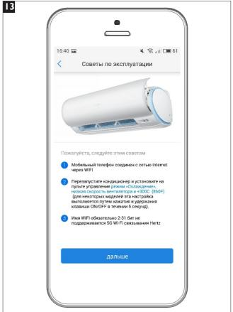
Перед выполнением привязки кондиционера (пункт 2 на рис.13), полностью обесточьте кондиционер (физически отключите от сети питания) на 2-3 минуты, а при первом включении сделайте нужные установки (пункт 2 на рис.13). Требуемая температура имеется ввиду 30 градусов, просто знак градуса в используемом русском шрифте отображается как ещё один ноль
