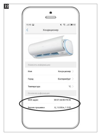
Старые Wi-Fi модули mod.25033107L на рис.19 подключены к серверу, который находится в КНР, из-за этого, при определенных обстоятельствах, могут возникнуть трудности доступа к серверу, поэтому мы рекомендуем обновить программное обеспечение старых модулей до новой версии программного обеспечения G\_1.0.00/e\_1.2.02 следующим образом:
