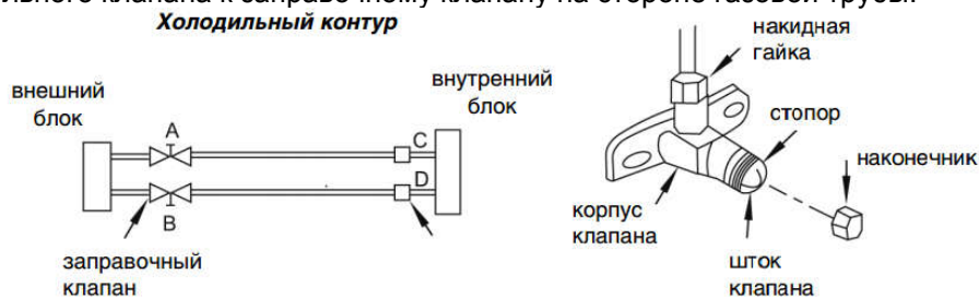
Рис. 15: Схема подключения холодильного контура
